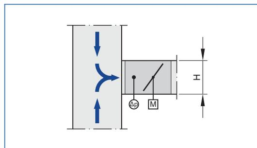
Le  $\Delta\dot{V}$  de précision du débit spécifié sera atteint même si le régulateur VAV est monté au niveau d'une intersection et du point de convergence de deux flux d'air.
