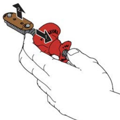
Fig. 131 : Remplacer la fusible
