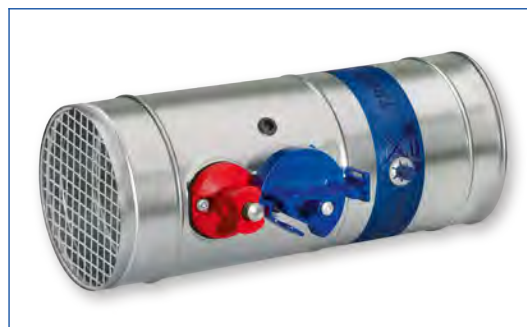
FKRS-EU avec fusible thermique et grille de protection pour une utilisation comme clapet de transfert
